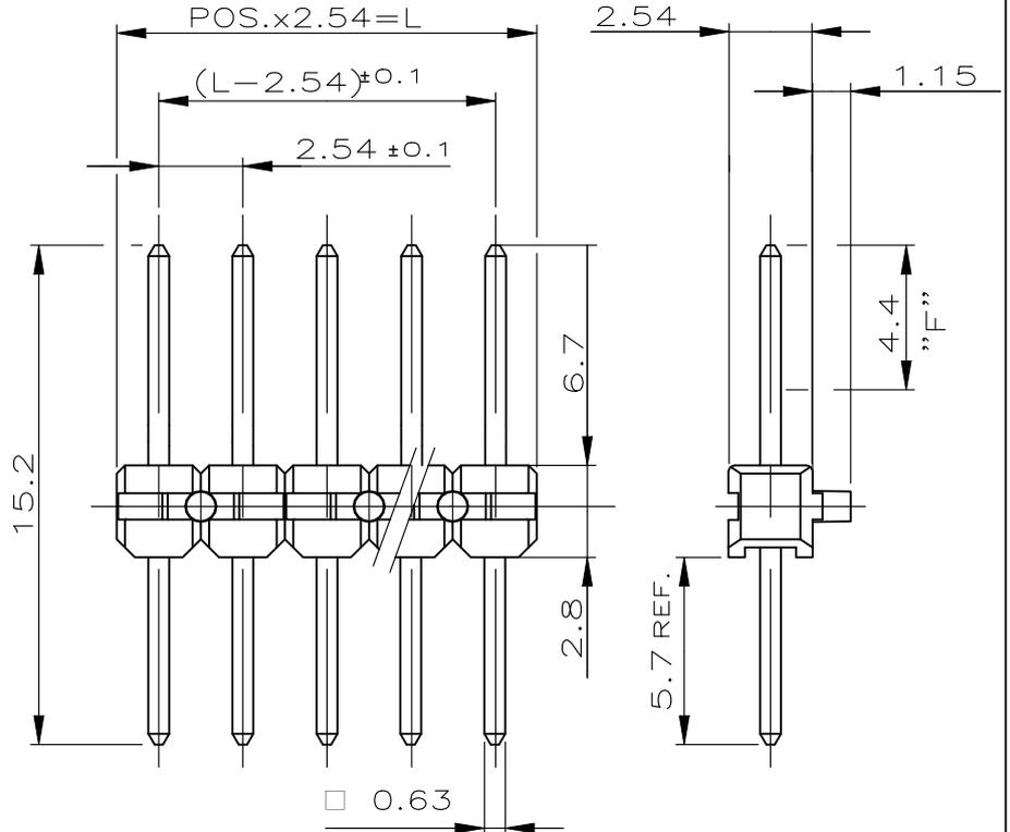
1 MATING SIDE: Min 0.76µm (PdNi + Au FLASH) IN ZONE "F" OVER Min 1.27µm Ni
