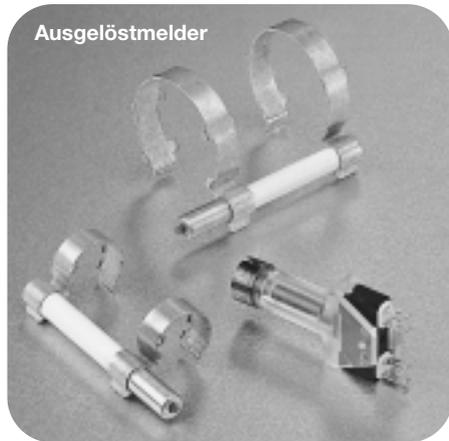
Sicherungen mit Ausgelöstmeldern sind für den parallelen Einsatz zusammen mit den Hauptsicherungseinsätzen erhältlich. Sie können entweder am zugehörigen Sicherungseinsatz befestigt oder separat in Sicherungsclips in Plattenmontage, Teile-Nr. CL1, eingebaut werden. Ein Steckadapter und ein Mikroschalter für die Anzeige im Fernbetrieb ist zur Verwendung mit dem Ausgelöstmelder erhältlich, Referenz MAI oder MBI.
