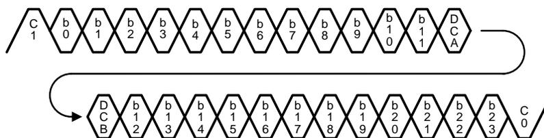
**Figure 13. FPD-Link II Serial Stream**
