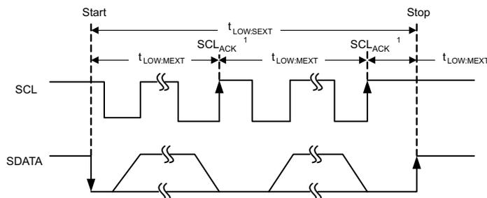
Figure 2. SMBus  $t_{\text{TIMEOUT}}$
