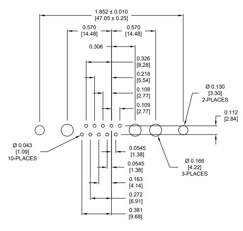
RECOMMENDED PCB LAYOUT TOLERANCE ± 0.002 [0.05]
